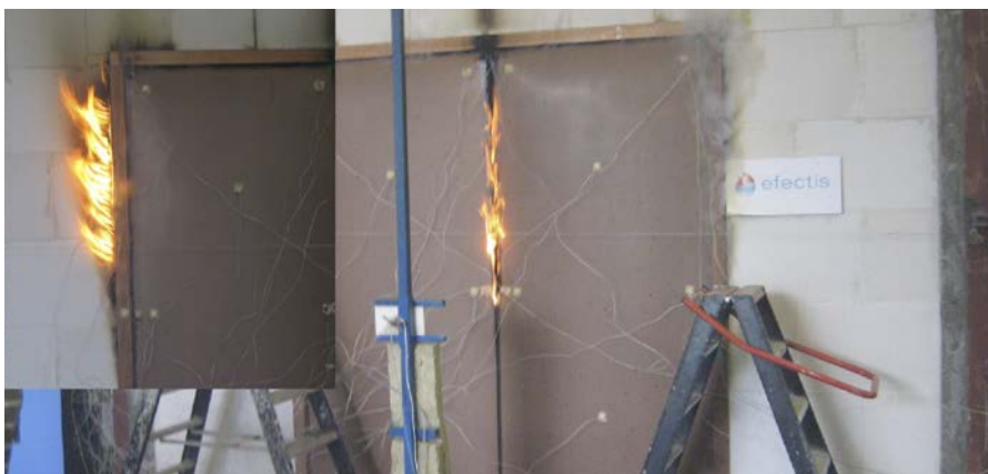
Figuur 7.5: Einde brandproef van een houten dubbele deur na 37 minuten.
