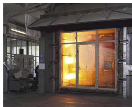
Figuur 7.1: Start brandproef van een enkele deur met twee zijlichten en een bovenlicht.
