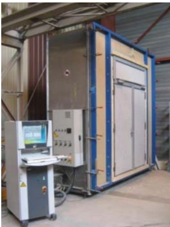
Figuur 1.16: Testopstelling op rookdoorlatendheid Sa en S200 te bepalen.
