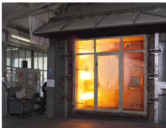
Afb. E.1: Start brandproef van een enkele deur met twee zijlichten en een bovenlicht.
