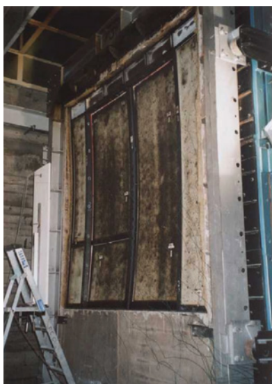
Afb. E.4: Brandproef van een schuifpui 3,2 m hoogte met brandwerend glas (het brandwerende glas is reeds opgeschuimd).
