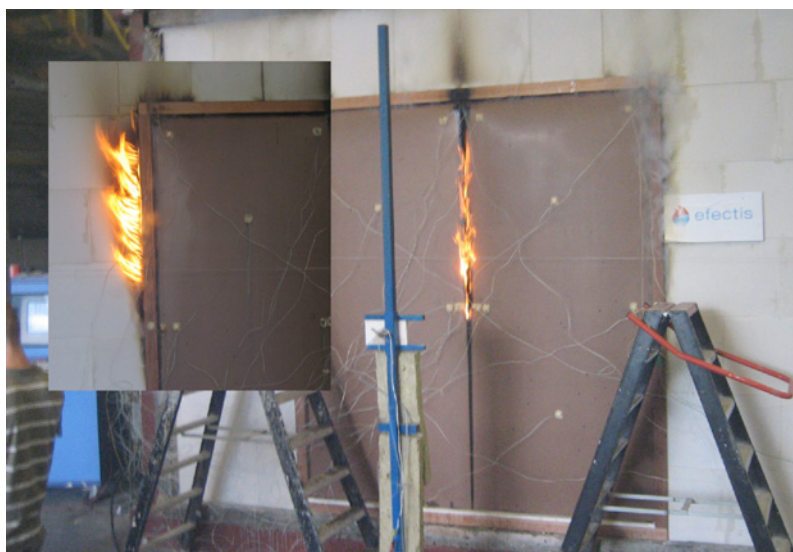
Afb. E.5: Einde brandproef van een houten dubbele deur na 37 minuten.
