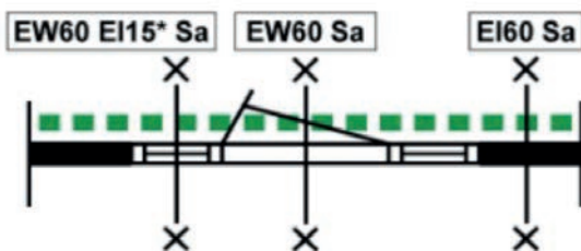
Figuur 6: Weergave eisen brandwerendheid en rookdoorlatendheid puiconstructie [bron NEN 1413]
