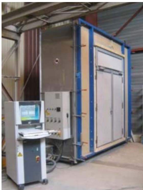
Figuur 16: Testopstelling op rookdoorlatendheid Sa en S200 te bepalen.
