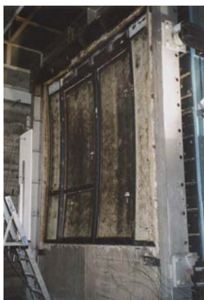
Figuur 31: Brandproef van een schuifpui 3,2 m hoogte met brandwerend glas (het brandwerende glas is reeds opgeschuimd).
