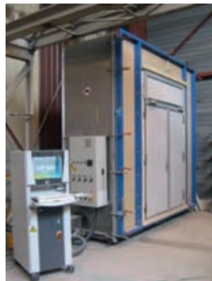
Figuur 13 Testopstelling op rookdoorlatendheid Sa en S200 te bepalen.
